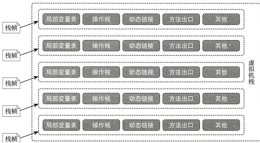
图 2-4 虚拟机栈结构图
